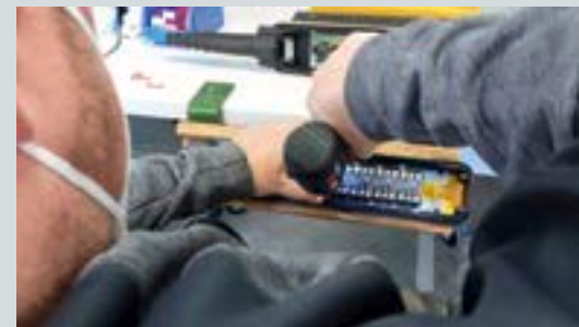
Leichter, einfacher, schneller: Am Pick-by-Light-Arbeitsplatz wird ein Steuerungsmodul sicher und fehlerfrei montiert.
