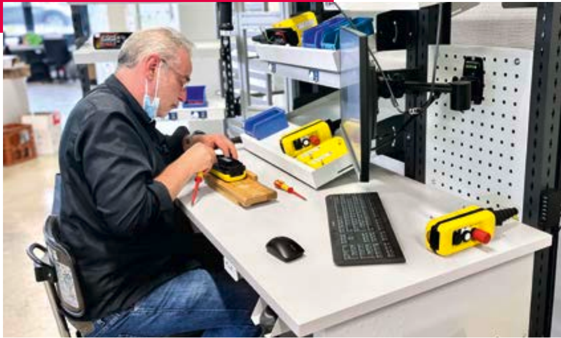
Dirk Röcher (56) setzt am Pick-by-Light-Arbeitsplatz Steuerungssysteme für Hebe- und Dachkrane mühelos und fehlerfrei zusammen.
